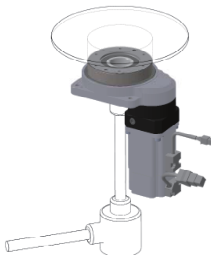
○ Hollow Hole을 활용한 Air 흡착구조
